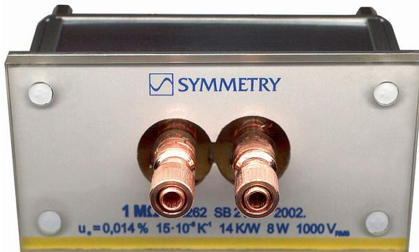
Namena ovih otpornika su vrlo tačna merenja otpornosti relativnim metodama, kao i etaloniranja ili baždarenja merača za otporne termometre, elektrohemijских konduktometara, ommetara, ampermetara, ili sklapanja tačnih razdelnika napona.
