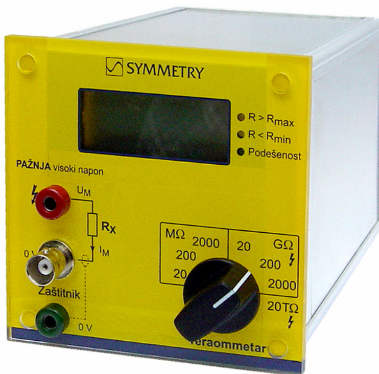
Slika 3. Teraommetar Symmetry SM304.
