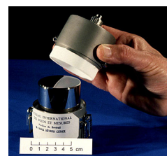
Slika 3. Čuveni međunarodni etalon kilograma u upotrebi od 1880. godine (od legure platina 90 % mase - iridijum 10 % mase) i desno, putujući transfer etalon kilograma za međunarodno poređenje (od nerđajućeg čelika). prema [BIPM]
